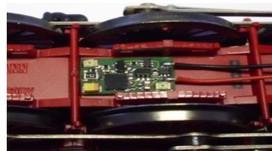
Positionierung des 68 330 unter der Lok
